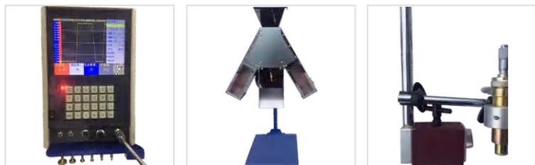
Измеритель длины внешней/внутренней пружины
