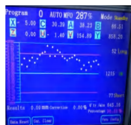
Измеритель длины внешней/внутренней пружины 外置/内置检长系统
